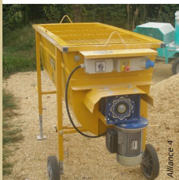
Malaxeur à axe horizontal, moteur électrique monophasé, optimisé pour le brassage du chanvre.
