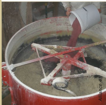
Les malaxeurs satellitaires, entraînés par prise de force ou moteur triphasé, sont économiques, résistants et permettent de malaxer de gros volumes.
