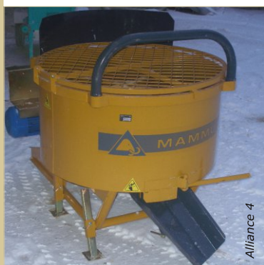
Les malaxeurs satellitaires sont issus du monde agricole. Les matières premières peuvent être chargés au godet. La sortie, dotée d'une goulotte, autorise de gros débits.
