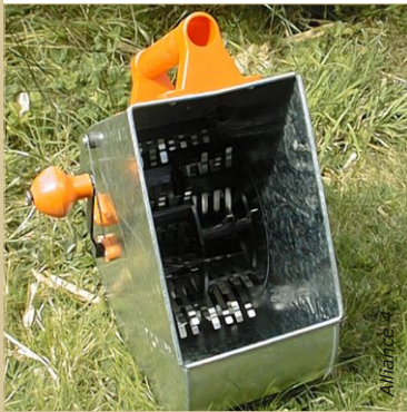
L'application du gobetis peut se faire avec une tyrolienne. Il peut aussi se projeter au sablon et son compresseur.
