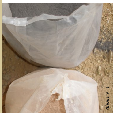
L'utilisation de poudre de marbre de couleur confère aux enduits des teintes harmonieuses et stables.
