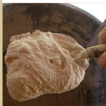
La consistance du mortier est ferme et onctueuse, suffisamment humide pour s'appliquer sans forcer.
