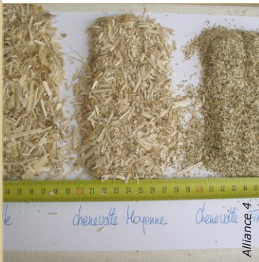
Il existe différents calibres de chènevotte pour des épaisseurs et des aspects différents d'enduit chanvre.
