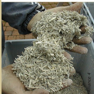
Le chanvre stabilisé est un mélange léger utilisé ici en remplissage du vide entre les briques de chanvre et le mur existant.
