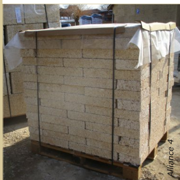
Lors du stockage, les palette de briques de chanvre restent ventilées.
