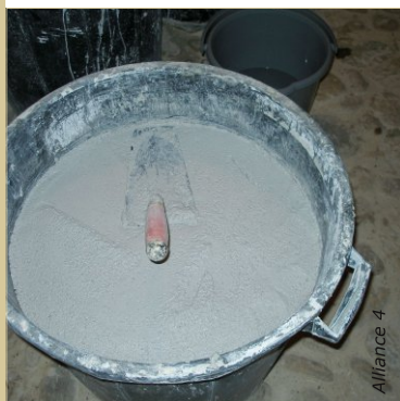
Le mortier de chaux aérienne/chanvre peut se préparer à l'avance et se conserve plusieurs semaines sous une couche d'eau.
