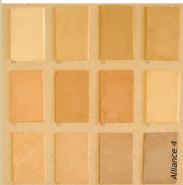
La formulation des enduits de finition avec des poudres de marbre colorées permet de nombreuses nuances.
